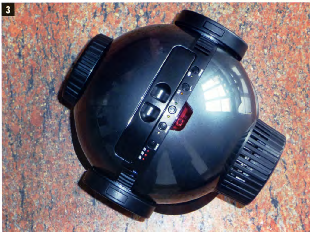
3. La sfera del proiettore con i comandi e il sensore (rosso) che "sente" gli impulsi del telecomando.
